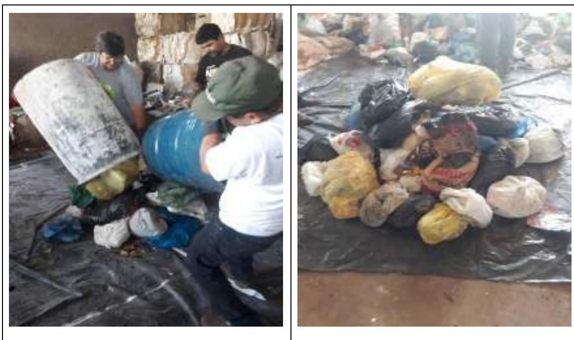
Figura 44: Disposição na lona dos resíduos das duas bombonas para o estudo da composição gravimétrica dos resíduos do município de Boa Vista da Aparecida/PR
