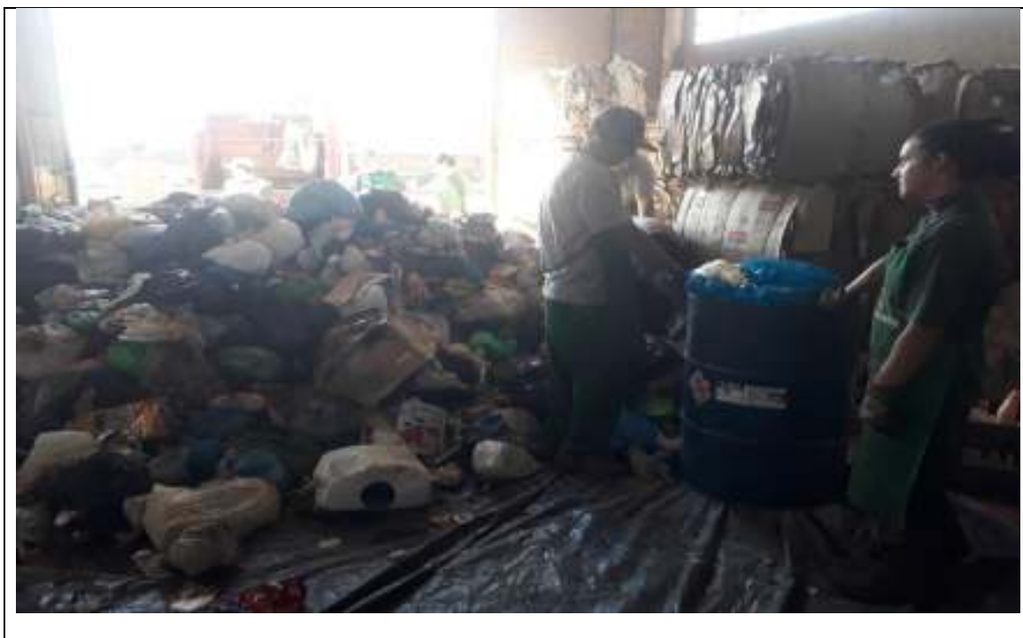
Figura 42: Realização do preenchimento das 04 bombonas com as sacolas de resíduos para o estudo da composição gravimétrica dos resíduos do município de Boa Vista da Aparecida/PR
