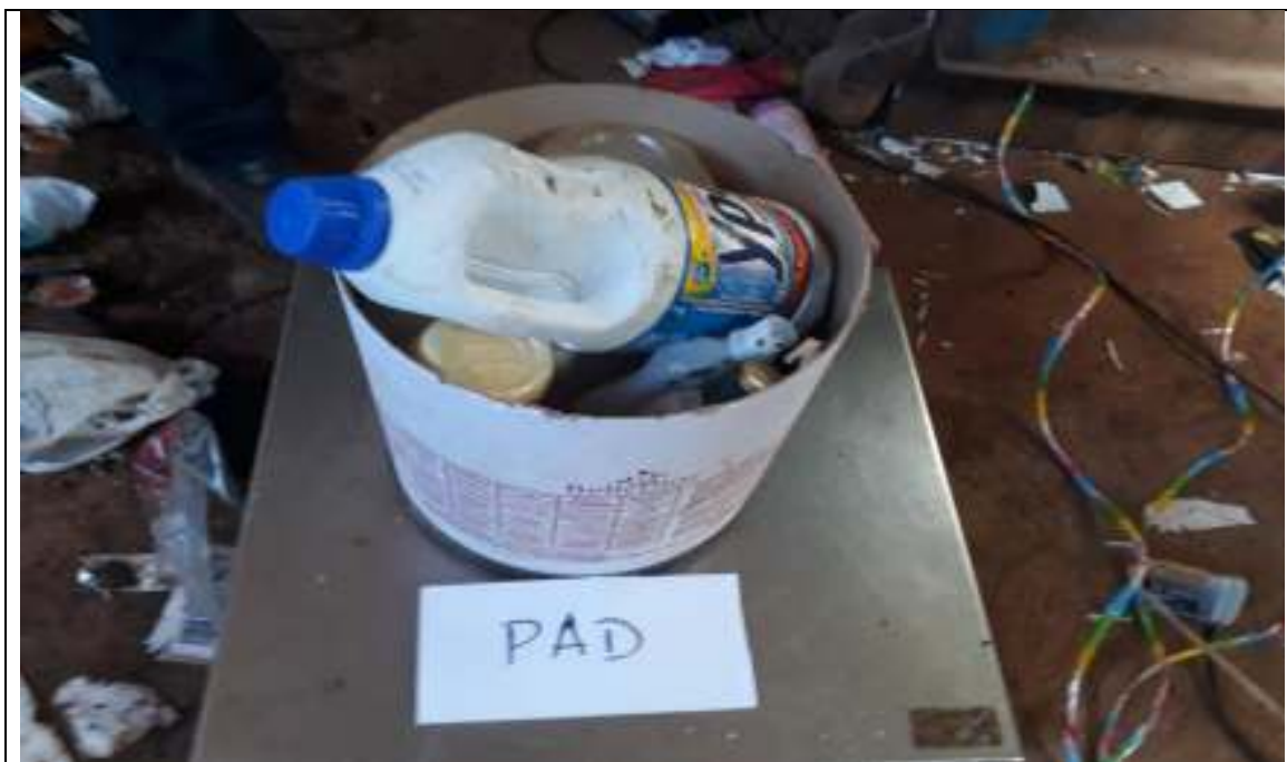
Figura 47: Pesagem de resíduos em balança digital, segundo sua tipologia, para o estudo da composição gravimétrica dos resíduos do município de Boa Vista da Aparecida/PR
